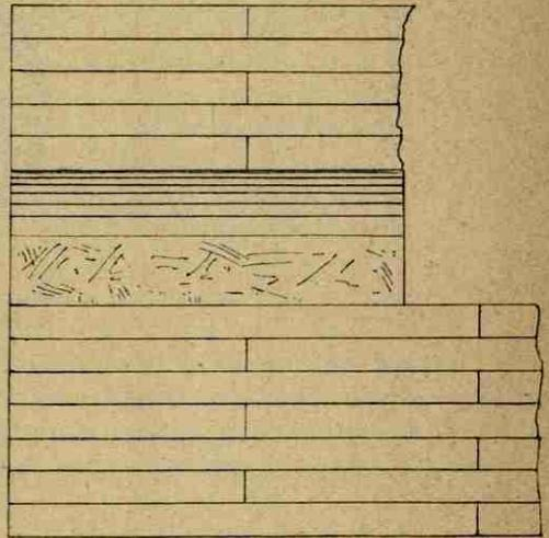
Particolari della cornice d'imposte e dello zoccolo delle pilastrate.
