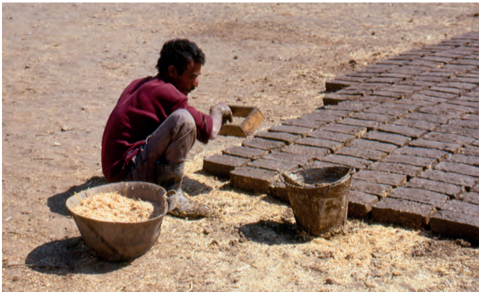
Abb. 2.15: Lehmziegelherstellung im heutigen Ägypten (Foto: D. Kurapkat 2001).
