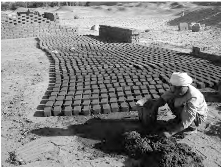
Abb. 1.2: Ziegelherstellung aus Nilschlamm in Athribis. Der mehrtägige Trocknungsvorgang führt zu großem Flächenbedarf (Foto: U. Fauerbach 2008).
